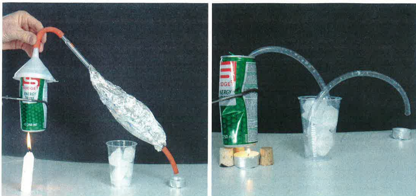
Abb. 6: Mögliche Varianten, der Wein-Destillation
